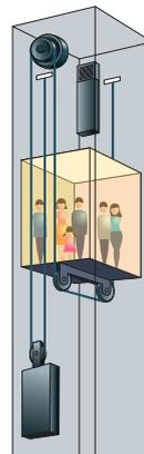
Todo el equipo está instalado en el cubo/pozo del ascensor. Sin el cuarto/sala de máquinas, el espacio en el cubo/pozo le da a los arquitectos y diseñadores de interiores mayor libertad de diseño.
